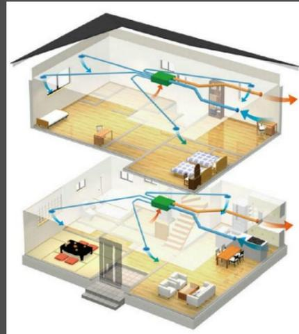
シックハウスの原因となる化学物質の室内濃度低減を目的に設置が義務化された24時間換気システム。熱エネルギーのロスを抑え、計画的な換気を行なうことで室内の空気をいつも新鮮に保ち、結露・ダニ・カビの発生を制御します。
